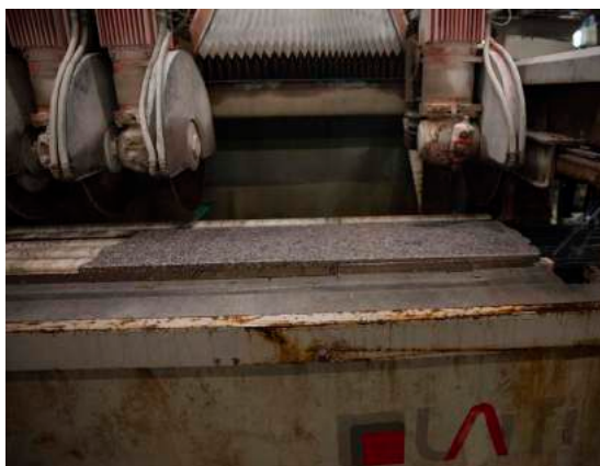
Le débitage-formatage des tranches : Le granitier utilise des débiteuses à disque diamantés, au diamètre adapté à l'épaisseur de la tranche.
